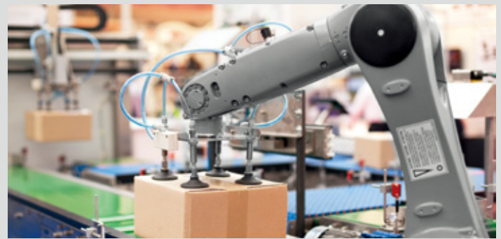
包装盒定位实现机器人精确抓取
