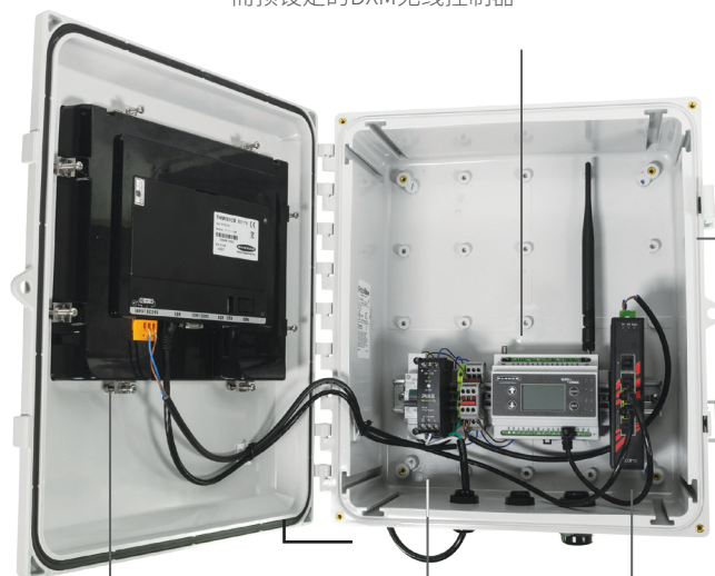
预先设定的10.1英寸 HMI 与通过LAN连接DXM
